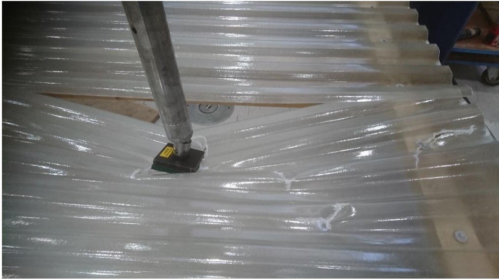
Abb. 2 Belastung bei Stoß zwischen den Traglatten.
