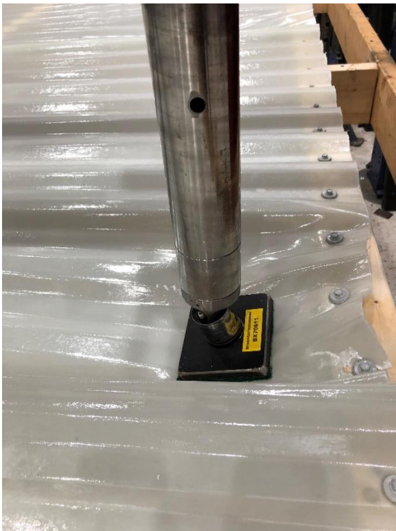
Abbildung 3 Belastung an der Kante.
