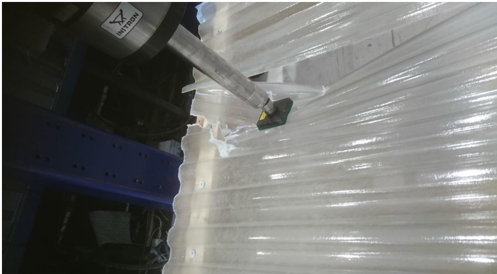
Abb. 3 Belastung an der Kante.
