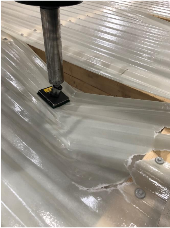
Abbildung 2 Belastung bei Stoß zwischen den Traglatten.
