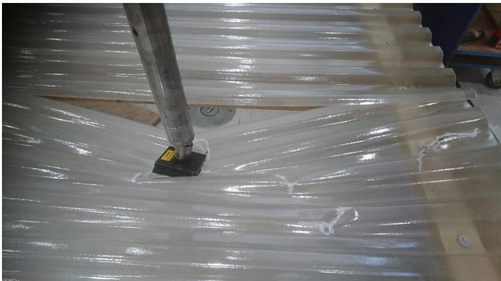
Figur 2 Belastning vid skarv mellan bärläkt.
