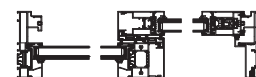
Monterat som ett Spegelvänt skjutparti - Utifrån sett Yttre luckan placerad till vänster.
